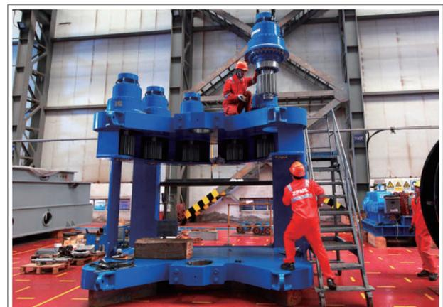
近日,振华重工自主研发的230吨液压绞车在南通传动开始装配。该绞车主要用于调整、预紧系泊缆绳,该项研发打破了国际垄断,助推浮式生产储卸油装置配套件实现国产化。 保建军摄影报道
